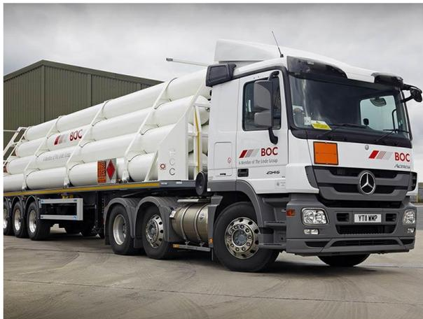
228 bar, vol. capacità≈23m<sup>3</sup> H<sub>2</sub> 450 kg
