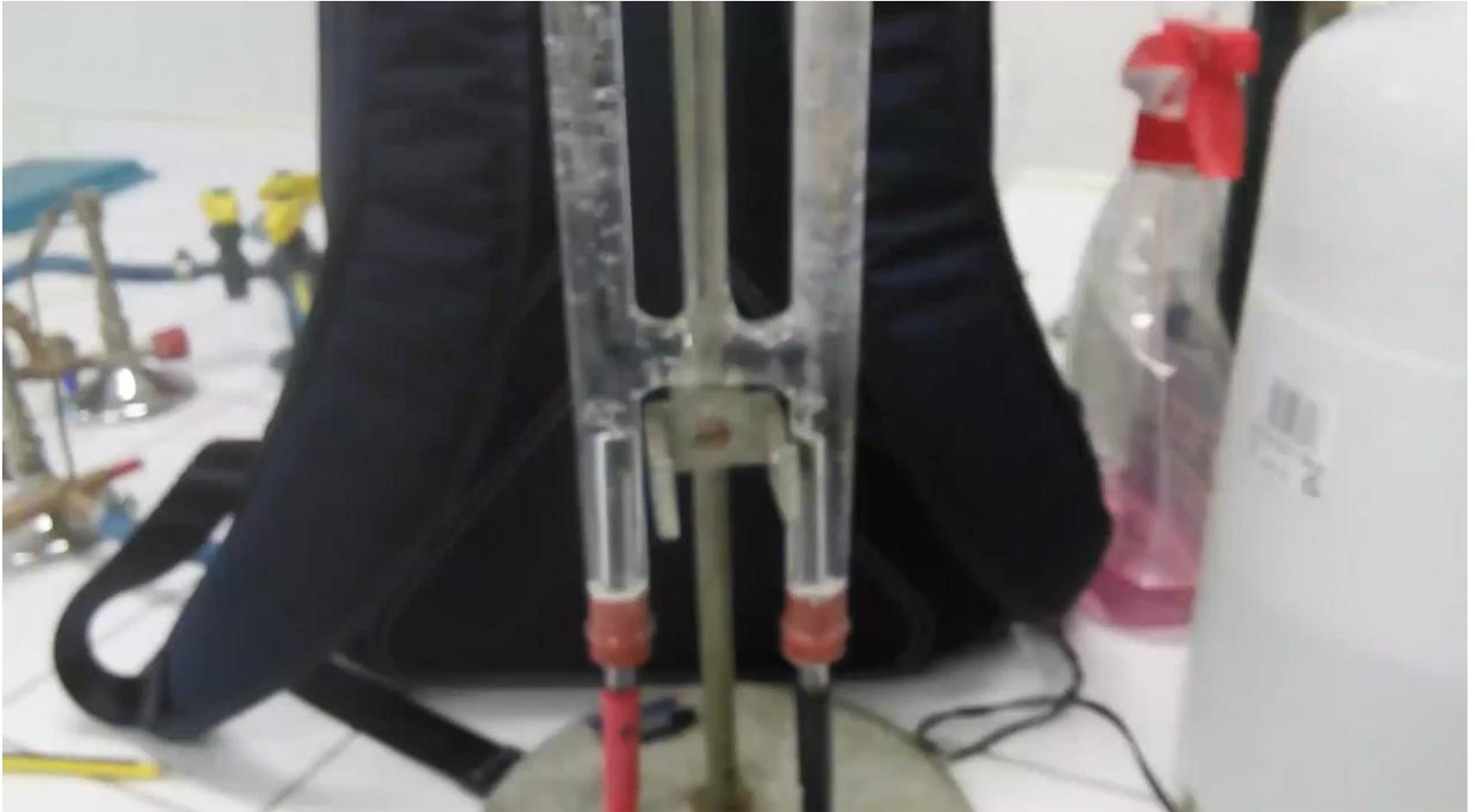
Voltmetro di Hofmann, impiegato per realizzare l'elettrolisi dell'acqua.
